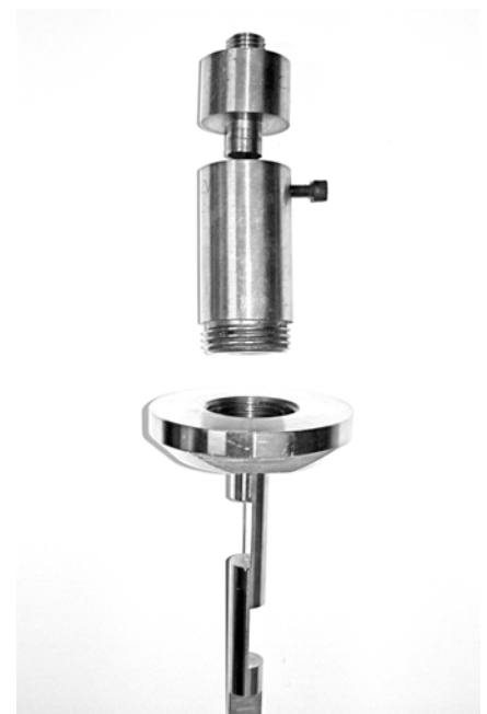
Figura 5. Foto di un monumento max-mount completo di caposaldo, in basso, e monumento con raccordo ruotante, in alto, il tutto costruito in acciaio inossidabile.
