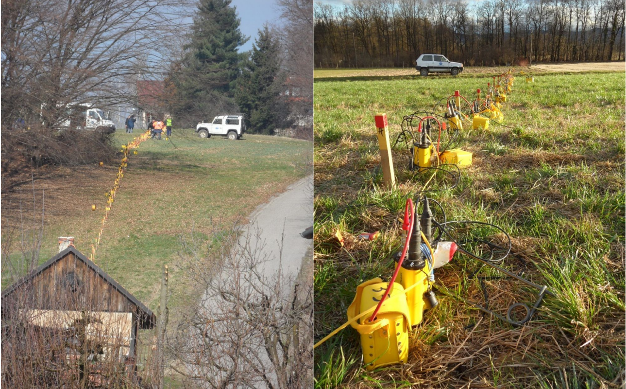
Indagine sismica a riflessione SH-wave per la caratterizzazione del sito Nuclear Power Plant Krško, Slovenia.
