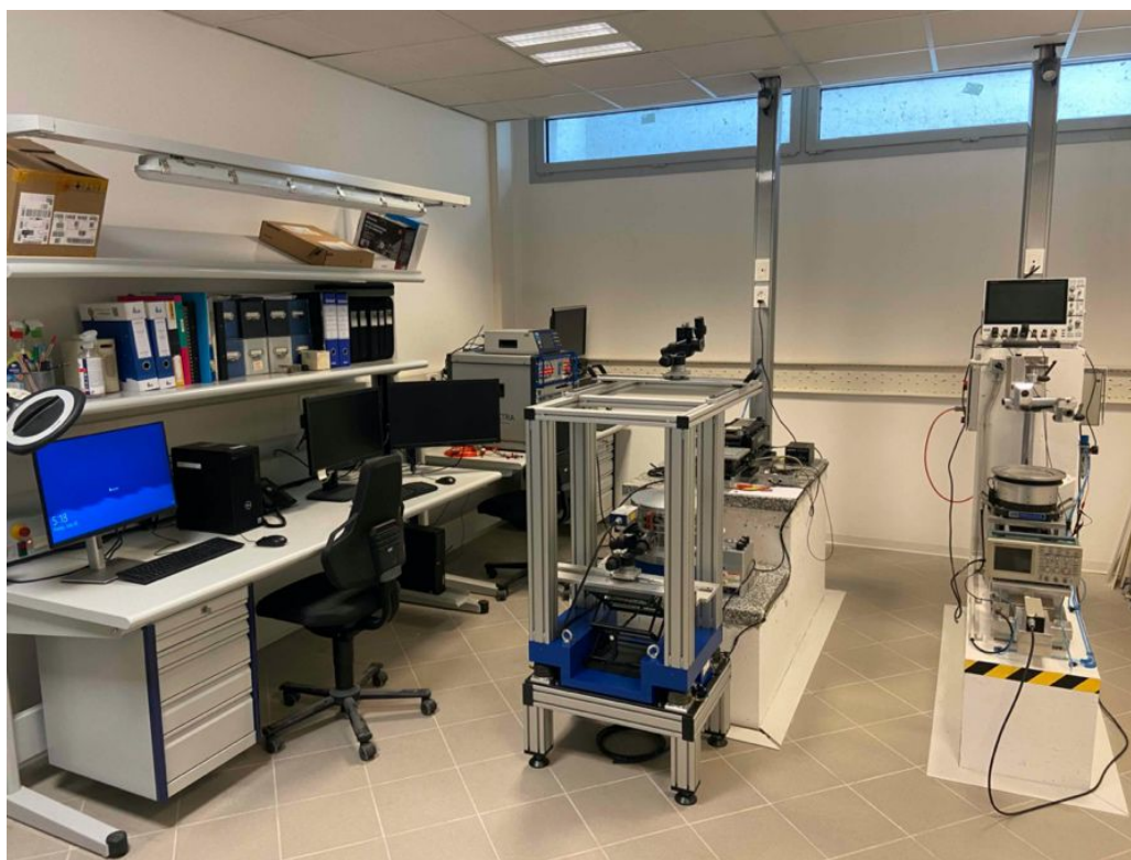
Laboratorio del Centro di Taratura Sismologico e tavole vibranti.
