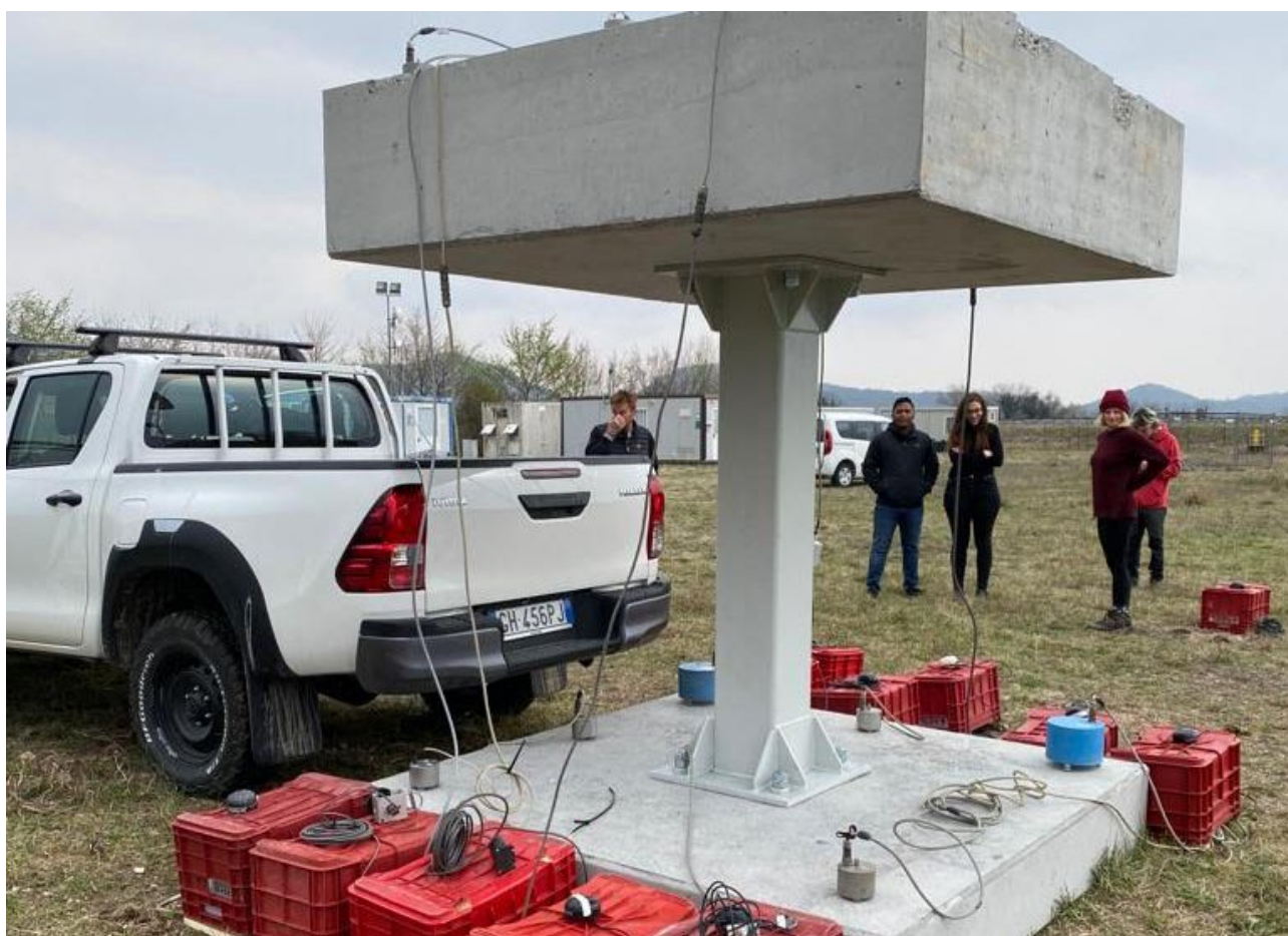
Esperimento per lo studio dell'interazione suolo-struttura.
