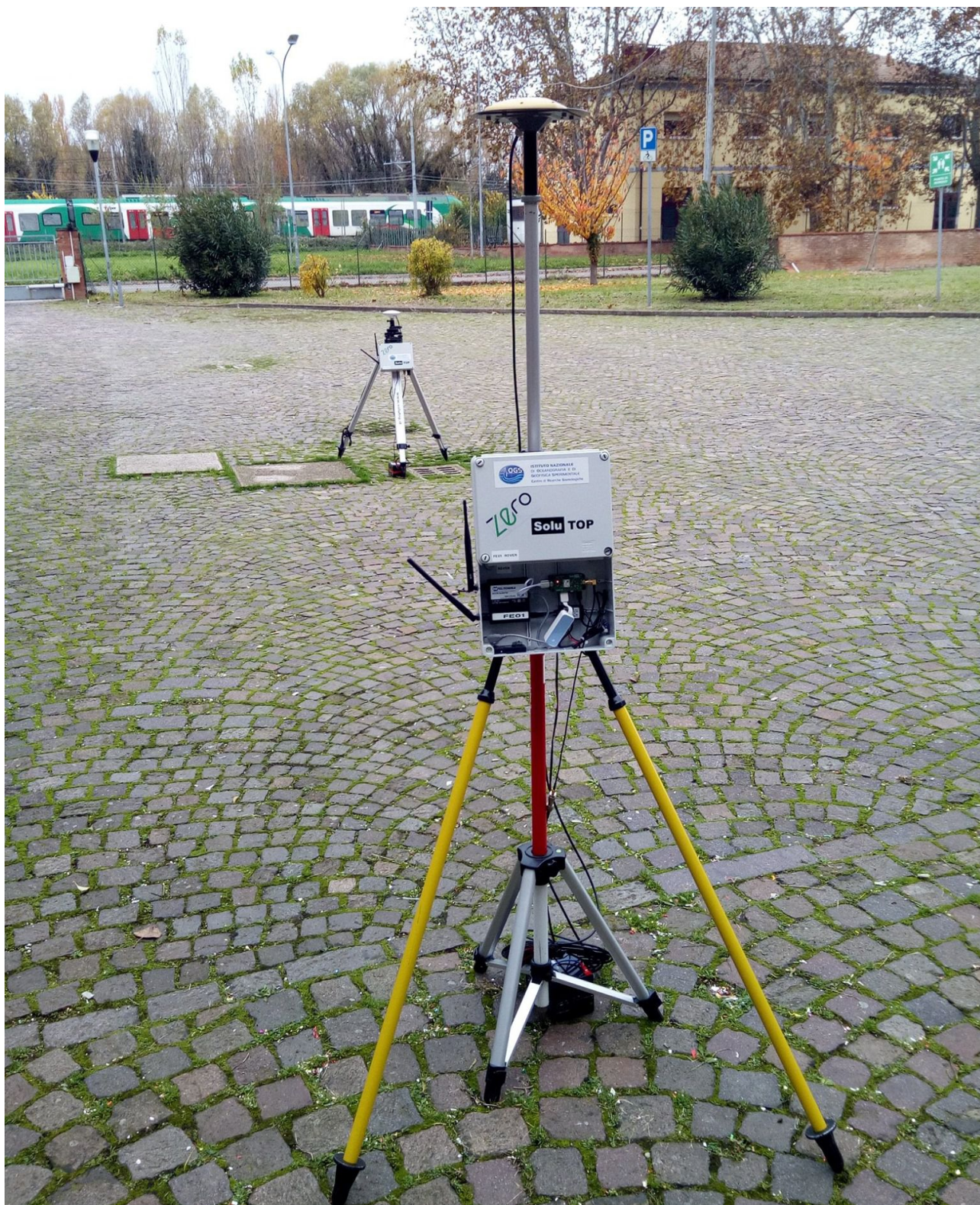
Strumentazione GNSS impiegata per rilievi di campagna.
