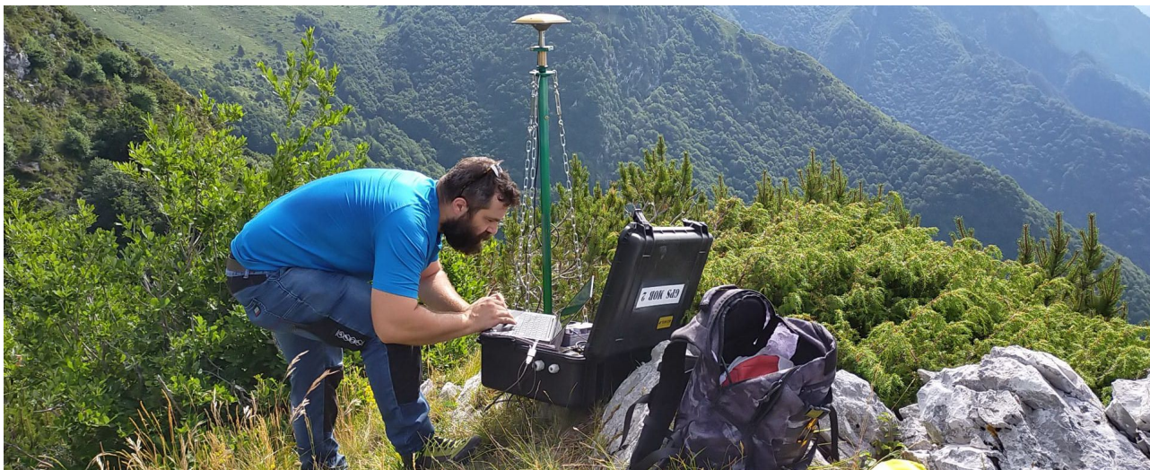
Monitoraggio di frane con sensori GNSS.
