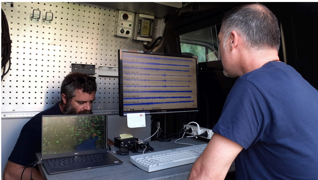
Monitoraggio sismico nel corso delle operazioni per neutralizzare un residuo bellico.
