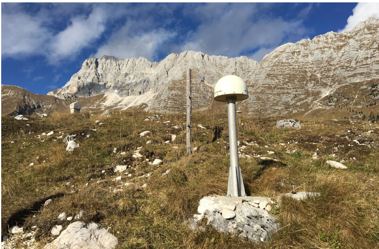
Antenna GNSS della rete SMINO installata sui Piani di Montasio.
