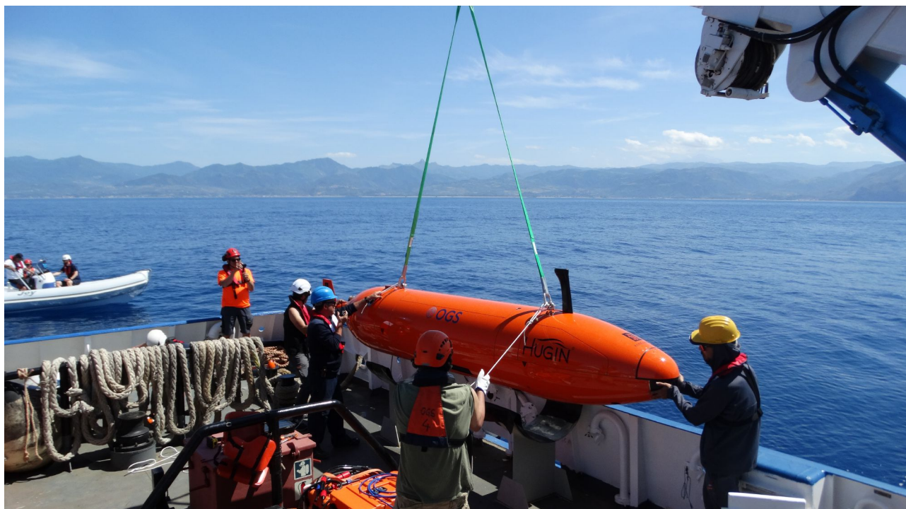
Veicolo autonomo sottomarino Hugin acquisito per l'ECCSEL-NatLab di Panarea.
