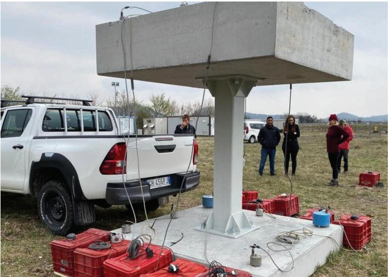
Esperimento per lo studio dell'interazione suolo-struttura.
