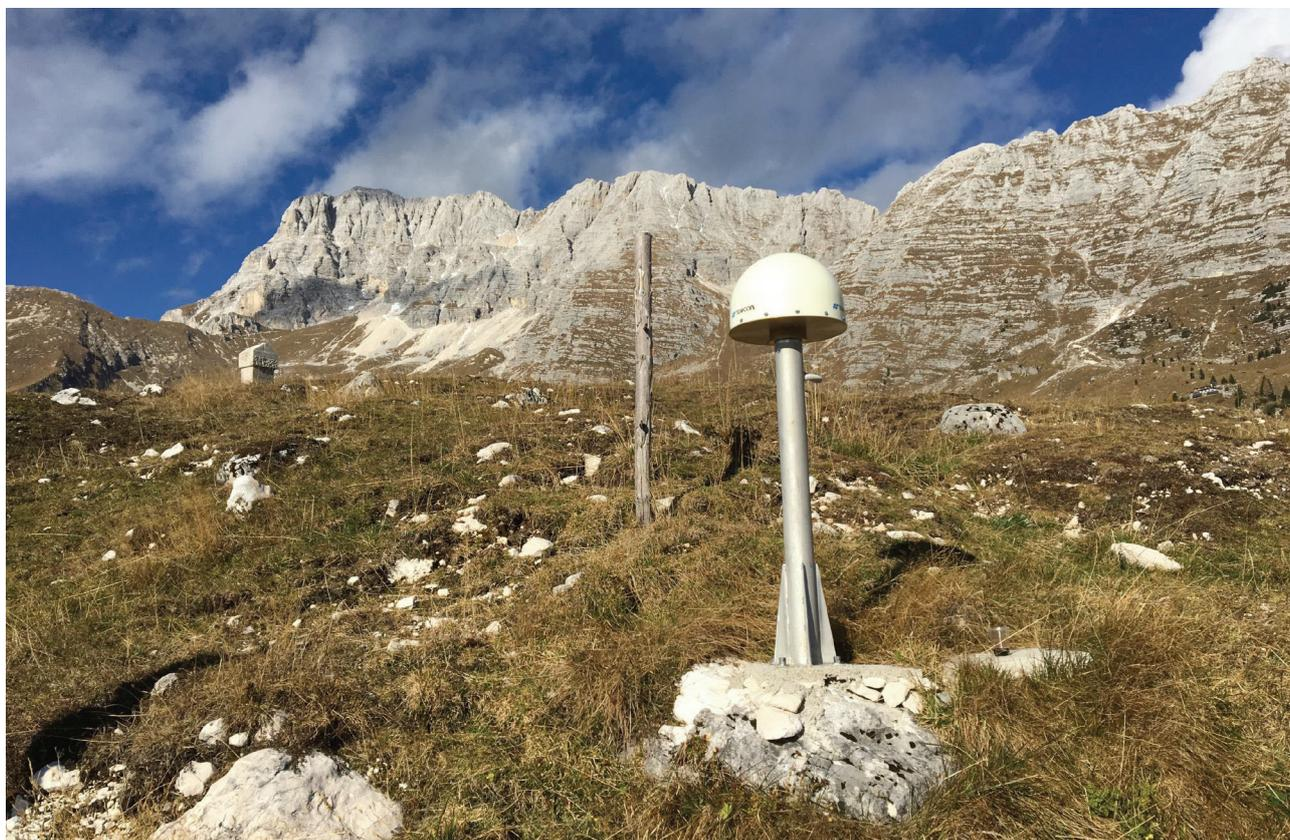
Antenna GNSS della rete SMINO installata sui Piani di Montasio.
