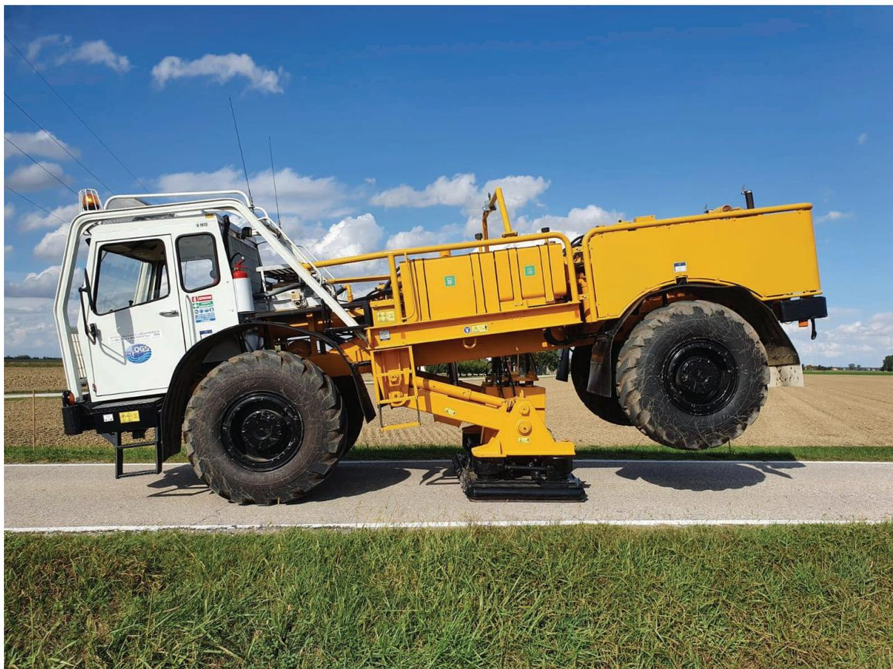
Vibroseis per rilievi sismici.
