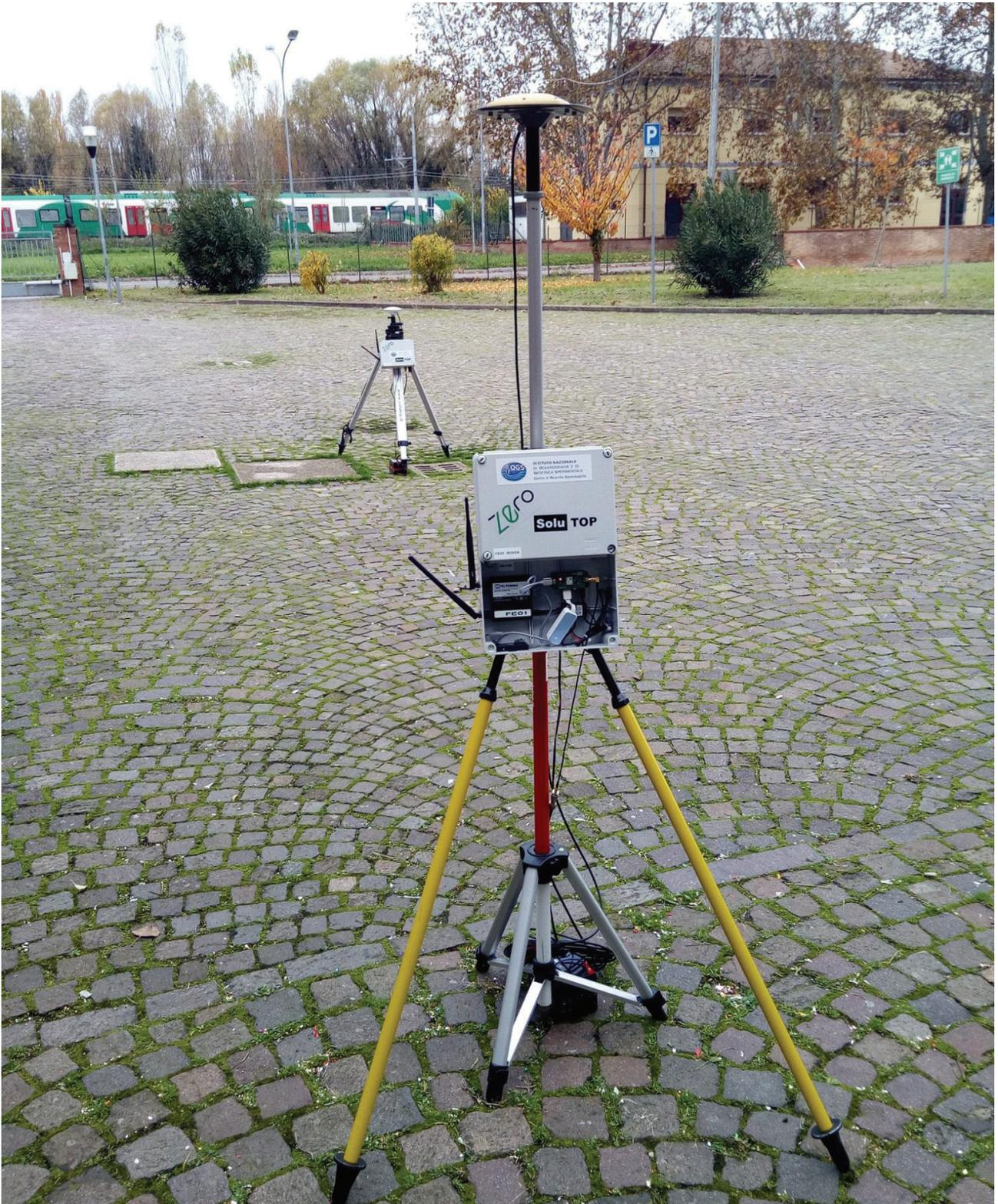
Strumentazione GNSS impiegata per rilievi di campagna.
